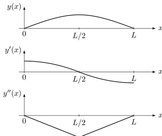
Die vertikale Verschiebung für  $y'(x)$  muss so gewählt werden dass  $y'(L/2) = 0$ . Begründet wird dies entweder durch Symmetrie der Auslenkung  $y(x)$  bezüglich  $x = L/2$ , oder durch die Randbedingungen  $y(0) = y(L) = 0$ , welche einen Punktsymmetrischen (bezüglich dem Punkt  $(L/2, 0)$ ) Graphen für  $y'(x)$  voraussetzen. Bemerkung: Es wird die Konvention verwendet dass  $y(x) > 0$  einer Auslenkung des Balkens nach unten entspricht.
