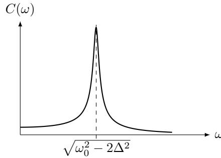
Die Funktion  $C(\omega)$  wird auch *Amplitudenfrequenzgang* genannt.
