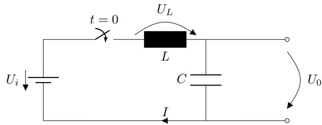
Die Batterie liefert die konstante Spannung  $U_i$  und wir interessieren uns für die Spannung über dem Kondensator  $U_0$ . Zum Zeitpunkt  $t = 0$  werde der Schalter geschlossen. Weiter befindet sich zum Zeitpunkt  $t = 0$  keine Ladung auf den Kondensatorplatten und es fliesset auch kein Strom, i.e.  $I(0) = 0$ . Aus dem Maschensatz ergibt sich
