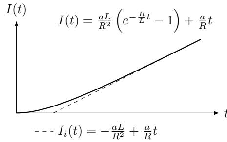
Das asymptotische Verhalten ist bei (i)  $I_i(t) = \frac{U_0}{R}$  und bei (ii)  $I_i(t) = -\frac{aL}{R^2} + \frac{a}{R}t$ , entsprechend der Lösung der inhomogenen Gleichung  $I_i(t)$ , welche für das Verhalten für grosse Zeiten massgebend ist.
