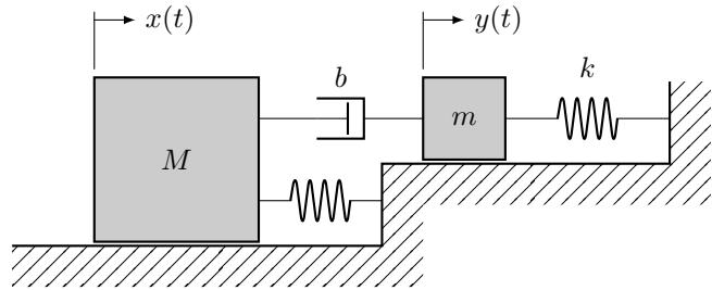
Die beiden Massen liegen reibungsfrei auf der Unterlage.  $x(t)$ ,  $y(t)$  sind die Auslenkungen aus den Ruhelagen. Die Federkonstanten der beiden Federn sind identisch.
