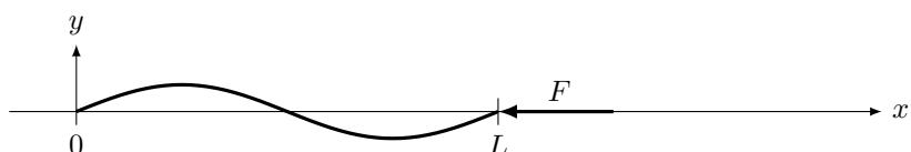
Im folgenden darf angenommen werden dass  $L = \text{konst.}$ , da die horizontale Verformung vernachlässigbar ist.
