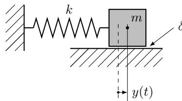
Die Masse sei  $m = 4$ , der Reibungskoeffizient sei  $\delta = 16$  und die Federkonstante sei  $k = 7$ . Wir bezeichnen mit  $y(t)$  die Auslenkung aus der (gestrichelt eingezeichneten) Ruhelage. Alle Angaben sind in SI-Grundeinheiten. Wir schreiben die Differentialgleichung zweiter Ordnung um auf ein System erster Ordnung. Mit  $y_1 = y$ ,  $y_2 = y'$  erhalten wir
