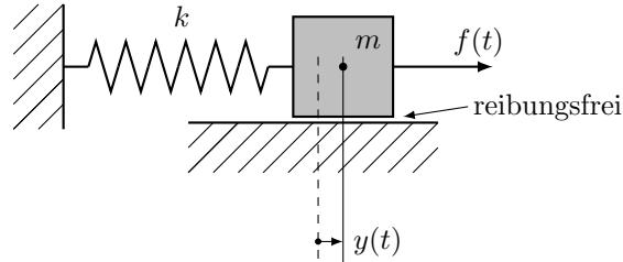
Wir bezeichnen mit  $m$  die Masse, mit  $k$  die Federkonstante und mit  $y(t)$  die Auslenkung des Körpers aus der Ruhelage. Es gilt  $m = k = 1$  und  $f(t)$  ist eine auf den Körper wirkende Kraft, gegeben durch
