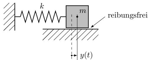
Wir bezeichnen mit  $m$  die Masse, mit  $k$  die Federkonstante und mit  $y(t)$  die Auslenkung des Körpers aus der Ruhelage. Der Körper werde aus der Ruhelage ausgelenkt und zum Zeitpunkt  $t = 0$  losgelassen. Wir interessieren uns für die Auslenkung aus der Ruhelage in Abhängigkeit der Zeit. Die Gesetzmäßigkeit welche dieses Problem beschreibt ist das
