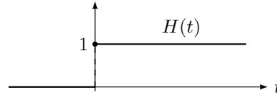
In Anwendungen wird diese Funktion meist verwendet um das (idealisierte) Einschalten (oder Ausschalten) eines Signals oder einer Störung zu modellieren. Beispielsweise kann eine Gleichspannung  $U_0$ , welche zum Zeitpunkt  $t = t_0$  eingeschaltet wird durch die Funktion
