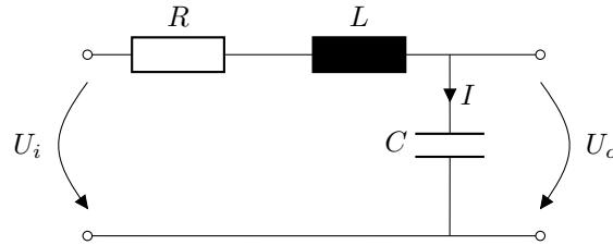
Wir bezeichnen mit  $U_i$ ,  $U_o$  die Eingangs- respektive die Ausgangsspannung dieser Schaltung. Der Maschengesetz für die Spannungen ergibt
