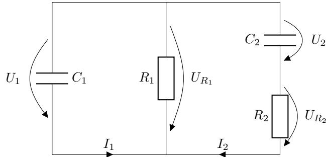
Der Maschensatz angewendet auf die rechte Masche ist  $U_2 + U_{R_2} = U_{R_1}$ , der Maschensatz angewendet auf die linke Masche ist  $U_1 = U_{R_1}$ . Mit  $U_{R_1} = -R_1(I_1 + I_2)$  und  $U_{R_2} = R_2 I_2$  ergeben sich die folgenden Gleichungen für die Ströme durch die beiden Kondensatoren in Abhängigkeit der Spannungen:
