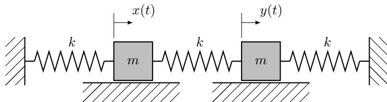
Die beiden Massen liegen reibungsfrei auf der Unterlage.  $x(t)$ ,  $y(t)$  sind die Auslenkungen aus den Ruhelagen. Die Bewegungsgleichungen für  $x(t)$ ,  $y(t)$  sind
