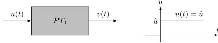
Aufgabe 27. Die Erwärmung eines Gleichstrommotors bei konstanter Verlustleistung  $P_v$  wird beschrieben durch die Differentialgleichung
