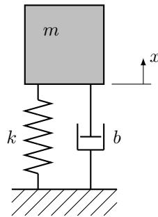
Es handelt sich um ein eindimensionales mechanisches Problem mit konstanter Masse  $m$ . Wir bezeichnen mit  $x$  die Auslenkung nach oben aus der vertikalen Lage, in welcher die Feder ungespannt ist (mechanisch entspricht dies der Lage in welcher das System während der Montage fixiert wird). Für die Bestimmung der Summe der wirkenden
