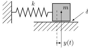
Es handelt sich um eine Masse, welche sich horizontal (und in einer Dimension) bewegen kann. Die Masse ist über eine (lineare) Feder mit der festen Struktur verbunden und es wirkt auf die Masse eine Reibungskraft welche proportional zur Geschwindigkeit ist.
