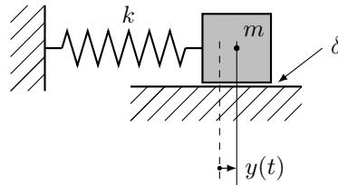
Die Masse sei  $m = 4$ , der Reibungskoeffizient sei  $\delta = 16$  und die Federkonstante sei  $k = 7$ . Wir bezeichnen mit  $y(t)$  die Auslenkung aus der (gestrichelt eingezeichneten) Ruhelage. Alle Angaben sind in SI-Grundeinheiten.
