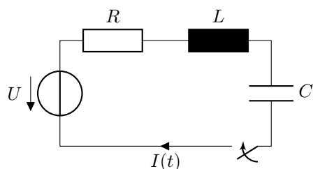
Zum Zeitpunkt  $t = 0$  befindet sich keine Ladung auf dem Kondensator. Zur Zeit  $t = 0$  wird der Schalter geschlossen.
