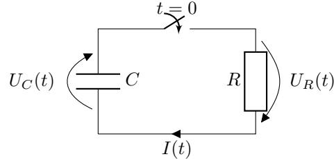
Auf dem Kondensator befindet sich eine Ladung  $Q_0$ . Zum Zeitpunkt  $t = 0$  wird der Schalter geschlossen. Wir interessieren uns für die Ladung  $Q$  auf dem Kondensator in Abhängigkeit der Zeit  $t$ . Die Gesetzmässigkeit zur Beschreibung der Situation ist die Kirchhoffsche Maschenregel:
